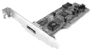
SATA/eSATA PCI Host Controller (UGT-ST300)
